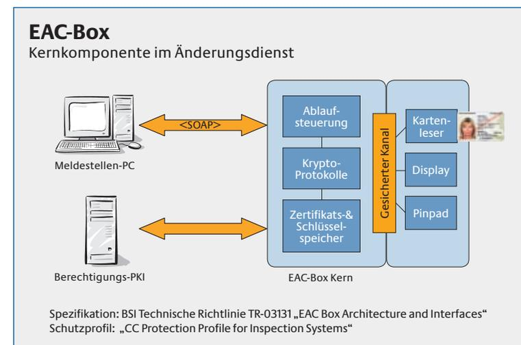
Die EAC-Box wird zur Einführung des elektronischen Personalausweises als Lesegerät zur Änderung der Adressdaten auf dem ePA in den Meldestellen der Kommunen eingesetzt werden. Neben diesem Szenario sind auch weitere Einsatzgebiete denkbar (z. B. Grenzkontrolle).
